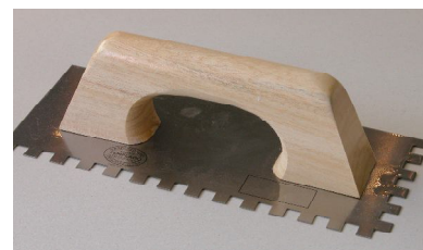
Aplicar ADIMAR TECNO FLEX con una llana dentada.
