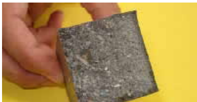
Mortero compacto de altísima resistencia.
